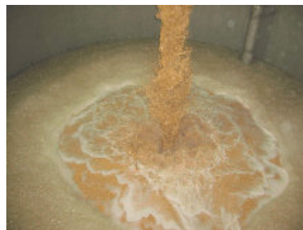
Tanque Maceração Steeping tank / Tanque de remojo
