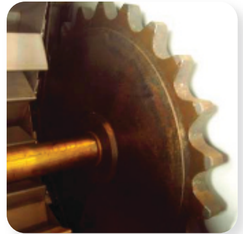
Engrenagem do elevador de canecas por correntes Buckets elevator gear by chain Engrenaje del elevador de cangilones por corriente
