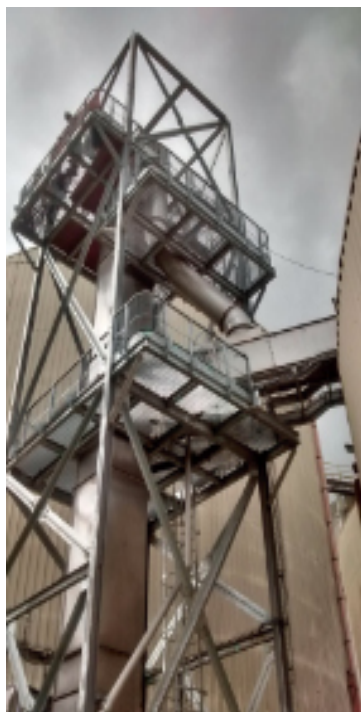
Elevador de canecas em inox Stainless steel bucket elevator Elevador de cangilones de acero inoxidable
