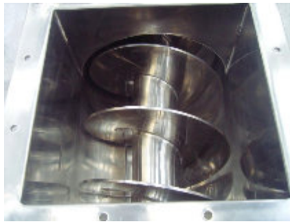
Rosca inox (Polimento - Grau sanitário) Stainless steel screw / Rosca de acero inoxidable
