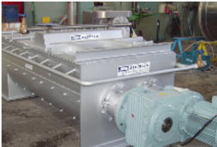
Rosca umidificadora para fly-ash / Humidifying screw for fly-ash / Rosca de humidificación para ceniza volante
